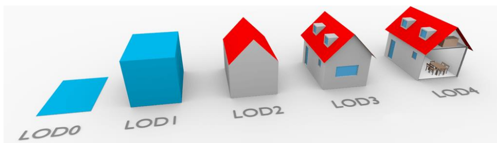
Figure 14 : Niveaux de détails des bâtiments : LOD1 à LOD4 (source : Université de Delft).
